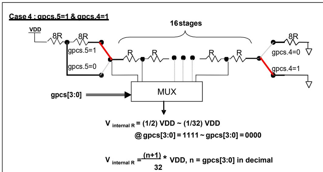
图 7:  $V_{\text{internal R}}$  硬件接法 (gpcs.5=1 & gpcs.4=1)
