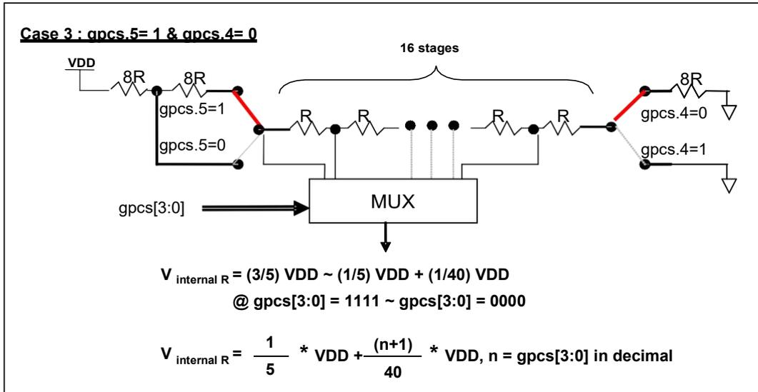
图 6:  $V_{\text{internal R}}$  硬件接法 (gpcs.5=1 & gpcs.4=0)
