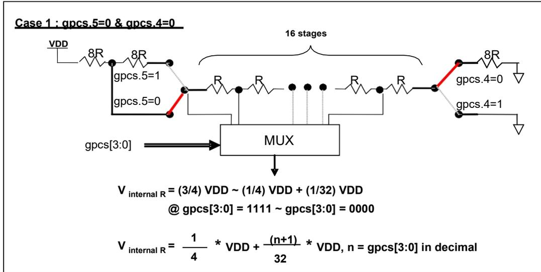
图 4:  $V_{\text{internal R}}$  硬件接法 (gpcs.5=0 & gpcs.4=0)
