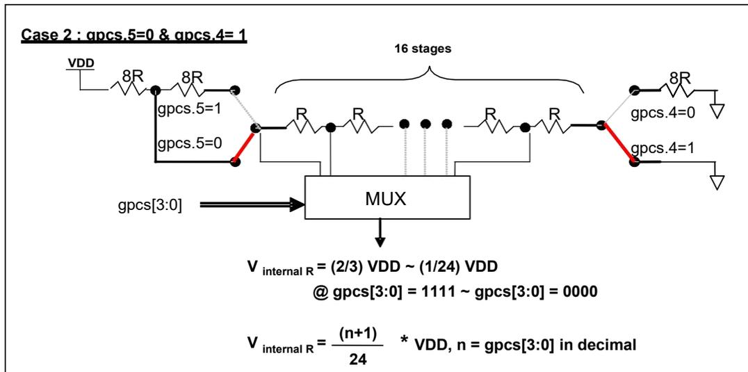
图 5:  $V_{\text{internal R}}$  硬件接法 (gpcs.5=0 & gpcs.4=1)
